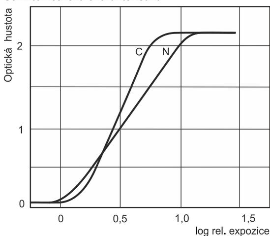
Uvedené křivky platí pro lesklý povrch. Jiný povrch, zejména matný, způsobuje pokles hodnoty maximální hustoty. Jednotlivým gradacím odpovídají následující senzitometrické parametry podle normy ISO:
