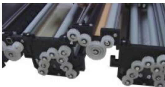
Vyndávací segmenty pro snadný přístup kvůli čištění.
